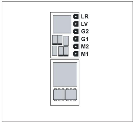
**M1, M2**.....Motoranschluss 1, 2
