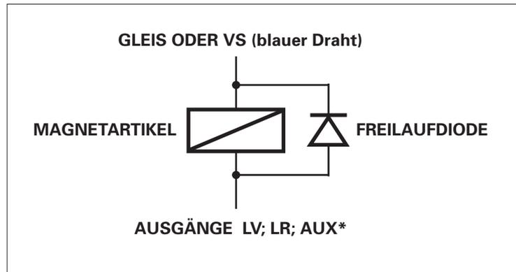
Bitte stellen Sie unbedingt sicher, dass der von Ihnen für den Anschluss der elektrischen Kupplung ausgewählte Funktionsausgang eine ausreichend hohe Belastbarkeit aufweist! Wir empfehlen die Anschlüsse AUX3 und AUX4 unserer Decoder, welche für Ströme bis zu 1 A ausgelegt sind.
